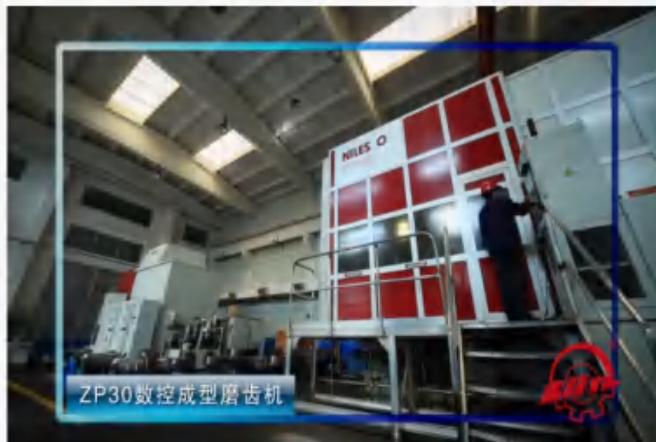
数控成形磨齿机 CNC formed gear grinder 德国纳尔斯 NILES, Germany 加工精度等级为4级 Machining accuracy up to Level 4 最大加工外齿3米，内齿2.5米价值人民币1500万元 Maximum machining of external teeth up to 3 m and internal teeth up to 2.5 m, with machining value of 15 million yuan
